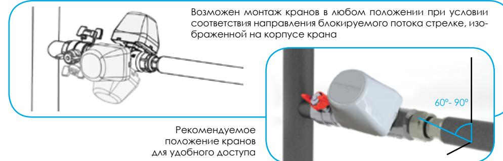
Возможен монтаж кранов в любом положении при условии соответствия направления блокируемого потока стрелке, изображенной на корпусе крана
